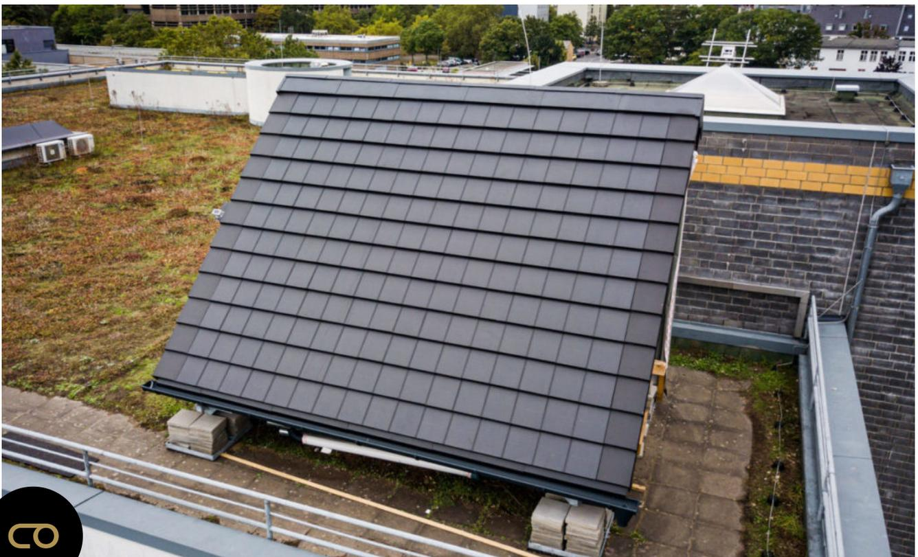
Das mit der Solardachpfanne eingedeckte Testdach lieferte im Leistungstest gute Ergebnisse.
